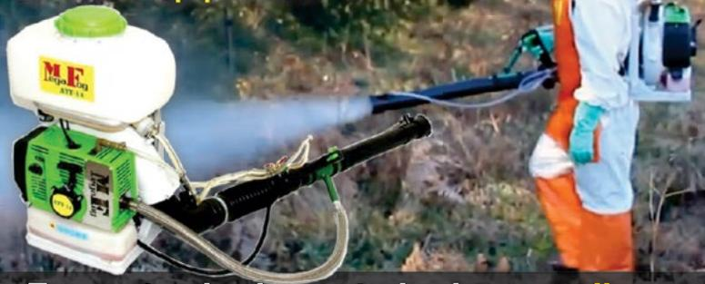
Termoatomizador motorizado a gasolina
